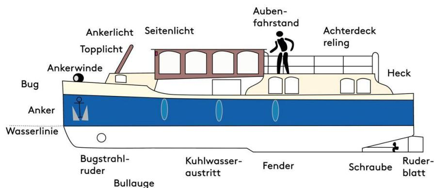
Als Achterdeck wird in der Schifffahrt der hintere Teil eines Schiffes beschrieben. Es ist ein wichtiger Bereich auf jedem Schiff, da man hier wichtige Ausrüstung und Funktionen finden kann wie zum Beispiel die Ruderanlage oder den Hauptantrieb eines Schiffes. Ebenso findet sich am Achterdeck oftmals die Navigationseinrichtungen, also Radar und GPS oder Rettungsboote und weitere Geräte für den Notfall.
