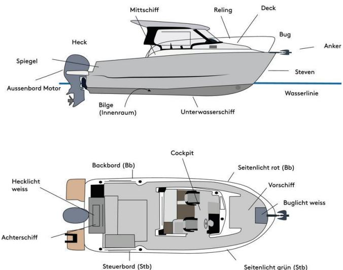
Das Achterschiff beschreibt den hinteren Teil eines Schiffes, der sich von der achteren Kante des Hauptdecks bis zum Heck des Schiffes erstreckt.
