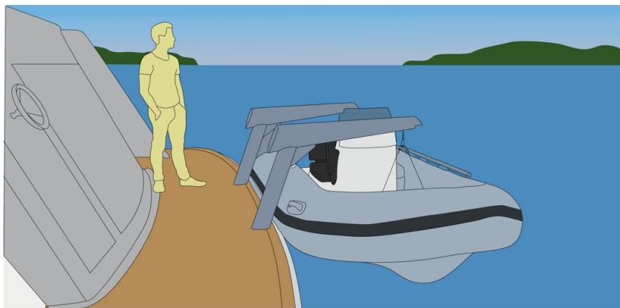
Davits sind Aufhängesysteme, mit denen Schiffe kleine Boote oder Beiboote tragen und starten können. Mithilfe einer Reihe von Kranarmen, die auf manchen Yachten am Heck montiert sind, können die Beiboote angehoben und ins Wasser gelassen werden.
