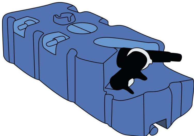
Der Fäkalientank ist ein Tank an Bord eines Schiffes, der speziell für die Sammlung und Lagerung von Abwasser und menschlichen Fäkalien ausgelegt ist. Es ist üblich, dass Schiffe ihre Abwässer nicht direkt ins Meer oder in den Fluss entsorgen, sondern alles in speziellen Tanks oder Anlagen aufbewahren, um es später an Land zu entsorgen.
