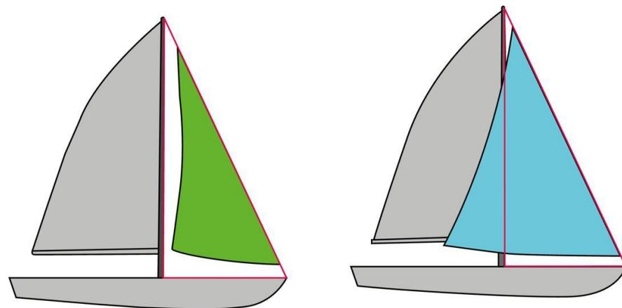
Genua ist ein Segeltyp, der anstelle der normalen Fock am Fockstag befestigt wird und bei leichtem bis mäßigem Wind zum Einsatz kommt. Die Genua ist größer als das Focksegel und oft genauso groß oder größer als das Großsegel. Eine Variante des Segels ist die Rollgenua, die durch ein Rollreffsystem einfacher zu handhaben und zu verstauen ist.
