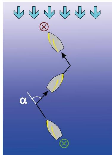
Kreuzen ist in der Schifffahrt eine Manövriertechnik, mit der man gegen den Wind auf ein bestimmtes Ziel zu segelt. Das Manöver wird auch Luv- und Lee-Wenden genannt, da das Schiff dabei abwechselnd auf verschiedenen Seiten des Windes segelt. Das Schiff "kreuzt" den Wind also immer wieder, sodass es Vortrieb bekommt, aber dennoch ein bestimmtes Ziel entgegen der Windrichtung erreicht.
