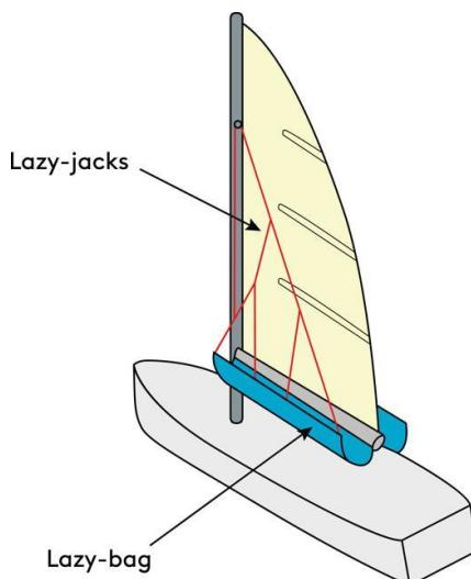
Der Begriff Faulenzer (zu Englisch: Lazy Jacks) hat in der Schifffahrt eine besondere Bedeutung. Es handelt sich dabei nämlich um eine Vorrichtung, die an Bord von Segelschiffen verwendet wird, um ein Segel leichter beim Bergen aufzutuchen. Der Faulenzer ist eine Art dünnes Seil oder Tau, das entweder um das Segel oder um den Baum (der horizontalen Stange, an der das Segel befestigt ist) gewickelt wird. Der Begriff wird im Deutschen nur selten benutzt, sondern eher die englische Übersetzung.
