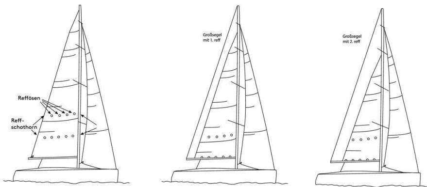
Das Verkleinern der Fläche eines Segels wird Reffen oder Einholen genannt. Da bei starkem Wind der Druck auf die Segel zunimmt, kann es nötig sein, das Segel einzuholen, um eine starke Krängung des Schiffs und übermäßige Belastung der Masten und Segel zu vermeiden. Dazu wird ein Teil des Segels herabgelassen und am Treffpunkt am Mast oder Baum befestigt.
