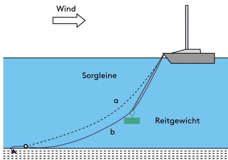
Das Reitgewicht ist ein Begriff aus der Schifffahrt und bezieht sich auf ein Gewicht, das an einem Seil oder einer Kette befestigt ist und dazu dient, die Stabilität eines Schiffes beim Ankern zu erhöhen.
