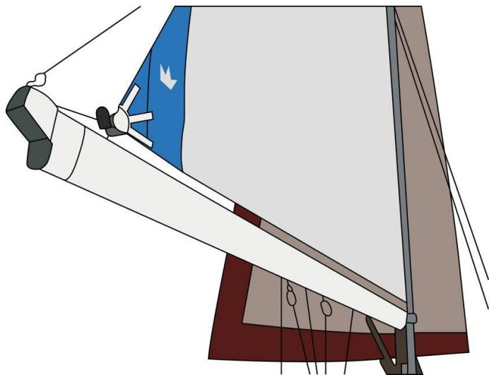
Eine Rollfock beschreibt ein Segel, das an der Vorderseite des Masts eines Segelschiffs angebracht ist und leicht Segelfläche und -form verändern kann. Die jeweilige Vorrichtung für das Aufrollen der Fock ist auch als Fockroller bekannt.
