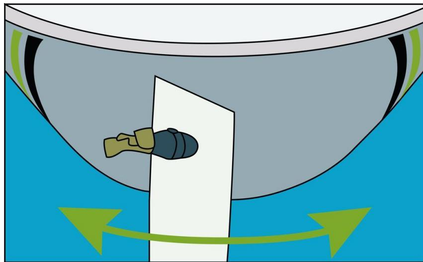
Das Ruderblatt ist ein Teil eines Rudersystems auf einem Schiff, das verwendet wird, um das Schiff zu steuern. Es besteht aus einer flachen Platte oder einem Flügel, das sich unter dem Rumpf oder am Spiegel befindet und durch das Ruderhorn oder den Ruderstock mit dem Rudersystem verbunden ist.
