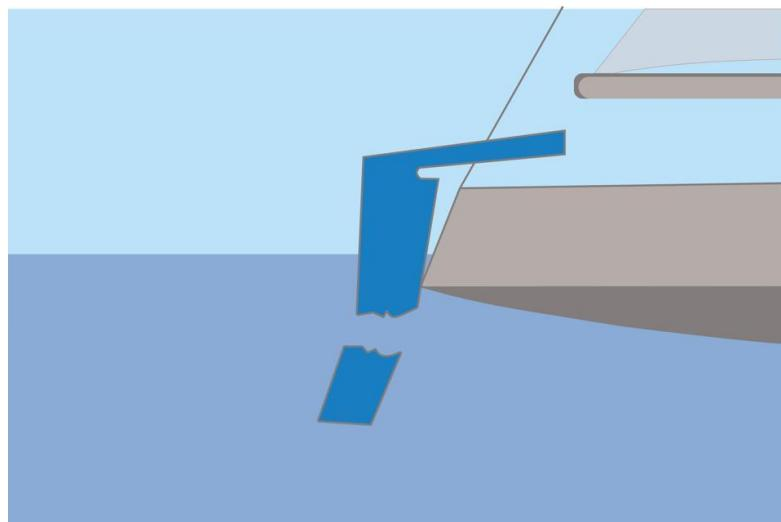
Ein Ruderbruch ist ein unvorhergesehenes Ereignis in der Schifffahrt, bei dem das Ruder eines Schiffes aufgrund von Bruch oder anderer Fehlfunktion nicht mehr ordnungsgemäß funktioniert. Dies kann zu einer unkontrollierten Bewegung des Schiffes und Steuerunfähigkeit führen, was eine ernsthafte Gefahr für das Schiff, seine Besatzung und andere Schiffe in der Umgebung darstellen kann.
