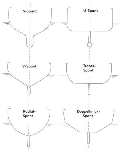
Der S-Spant ist eine Form des Schiffsrumpfs, die oft in der Schifffahrt verwendet wird. Darüber hinaus ist es eine Weiterentwicklung des V-Spantes und zeichnet sich durch seine spezielle Form aus, die eine hohe Geschwindigkeit und Stabilität ermöglicht.
