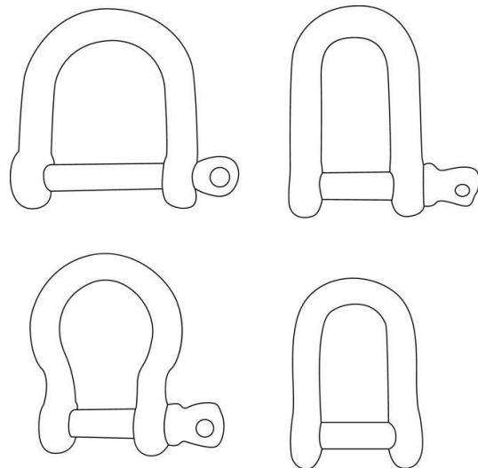
Schäkel sind Bügel aus Eisen, Stahl oder Bronze, die mit einem Bolzen verschlossen werden und dazu dienen, Leinen, Ankerketten oder Segel miteinander zu verbinden. Ein Schäkel sollte dabei nie um mehr als 40% seiner Bruchlast belastet werden.
