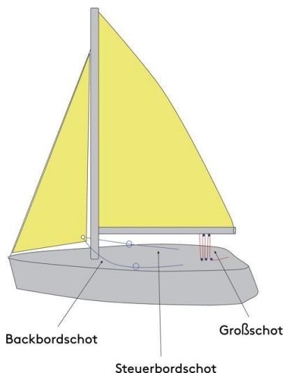
Eine Schot ist eine Leine, mit der das Segel in die richtige Position zum Wind gebracht werden kann. Je nach Einsatzbereich haben die Schoten unterschiedliche Durchmesser und Belastbarkeiten: Die Großschoten für die Großsegel sind zum Beispiel deutlich dicker als die Schoten für kleinere Segel wie das Fock oder Genua.
