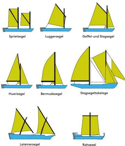
Alle Segel, die in Ruhestellung in Richtung der Schiffslängsachse gesetzt sind, werden unter dem Begriff Schratsegel zusammengefasst. Dazu gehören Gaffelsegel, Stagsegel und Schonersegel.
