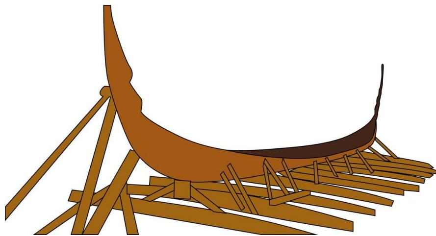
Der Vorsteven ist der vordere Teil des Schiffsgerüsts, an dem die Bugwände zusammenlaufen. Liegt der Vorsteven niedriger als die Schiffsmitte, spricht man von einem negativen Vorsteven.
